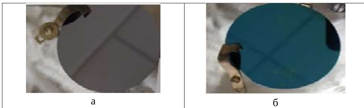
Рис.5- Кремниевые пластины до (а) и после (б) осаждения покрытия
