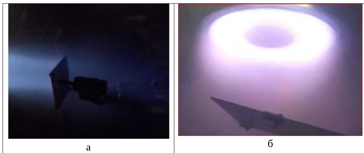
Рис.3-Процесс плазменной обработки (а) и магнетронного распыления (б)
