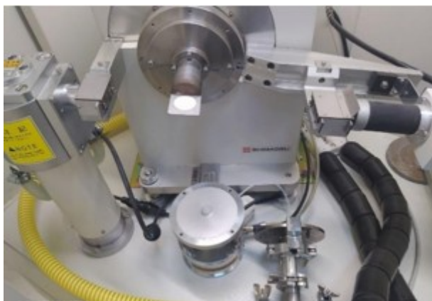
Рис2. Порошковый рентгеновский дифрактометр XRD-6100.
