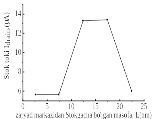
6-rasm. Zatvorga 1 V qiymat berilganda lokal zaryadning kanal bo'ylab turli vaziyatlari L da stok toki o'zgarishi
