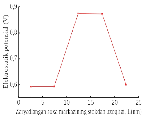
5-rasm. zatvor osti 1nm chuqurlikda kanal bo'ylab potensial taqsimotni L vaziyatga bog'liq o'zgarishi.
