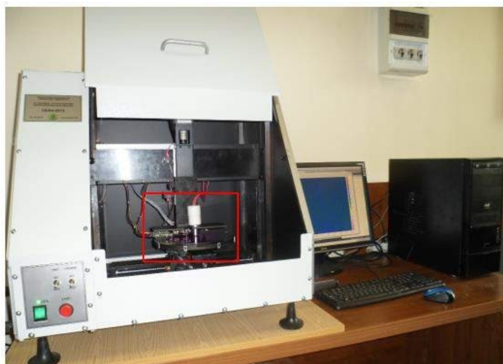
Рисунок 3 – Общий вид установки СКАН-13: 1 – цифровой измеритель КРП; 2 – консоль для размещения источников излучающего воздействия; 3, 4 – приводы трехкоординатного сканирования; 5 – предметный столик; 6 – исследуемый образец
