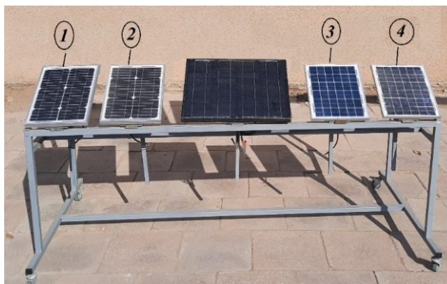
1-rasm. PV modul parametrlarini tabiiy sharoitda o'lchash jarayoni
