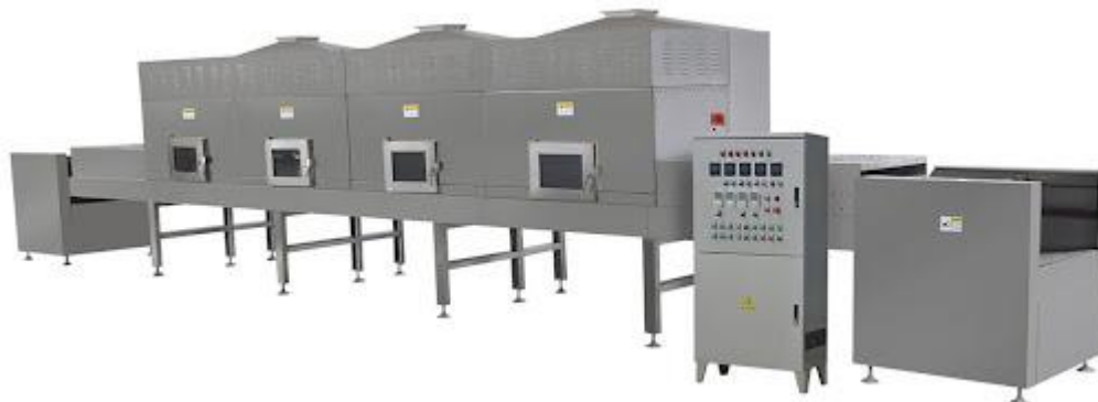
Рис 1. Промышленная микроволновая туннельная сушилка
