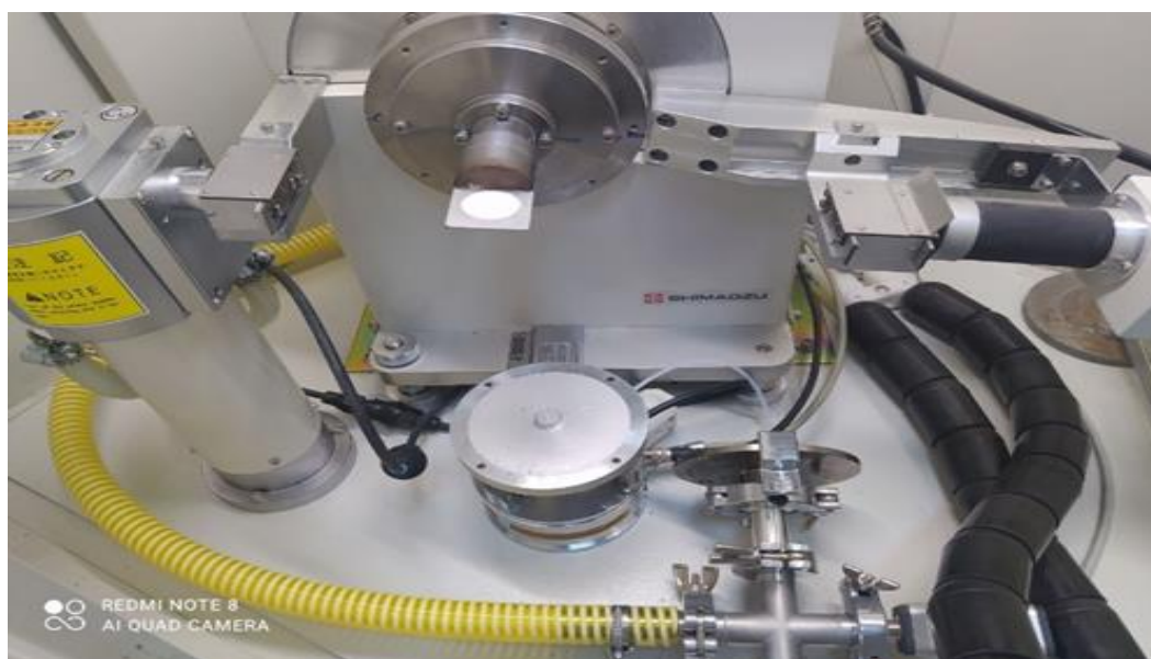
Рис.1. Порошковый рентгеновский диффрактометр XRD-6100.
