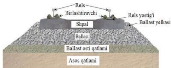
a) Temir yo'l ballast qismining ko'ndalang ballast qismini loyixalash sxemasi b) temir yo'l ballast qismining ko'ndalang qirqim ko'rinishi
