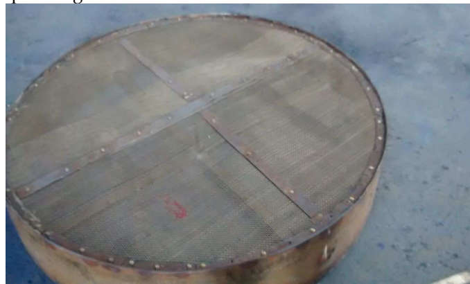
2-rasm. Toʻldiruvchi material keramzit bilan toʻldirilgan changgaz tozalash uskuna filtr koʻrinishi
