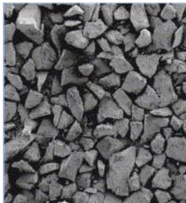
3-rasm. Kukun materialini olish usuliga qarab, zarrachalarning morfologiyasi va teksturasini namoyon bo'lishi: a) mexanik usul bilan olingan kukun zarrachalari; b) eritib dispersiyalash usuli bilan olingan kukun zarrachalari.
