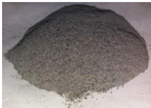
Рисунок а. 1 б. зеленый ингибитор коррозии, полученный при сжигании. измельченный зеленый ингибитор коррозии
