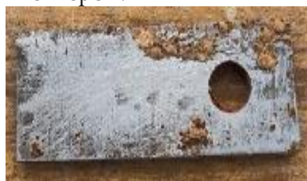
3б. Фотография образца металла в присутствии ингибитора.
