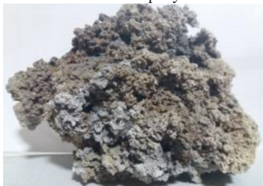
Рисунок а. 1 б. зеленый ингибитор коррозии, полученный при сжигании. измельченный зеленый ингибитор коррозии
