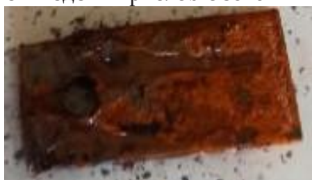
Рисунок-3. 3а. Фото стала 20 в водных условиях без ингибитора
