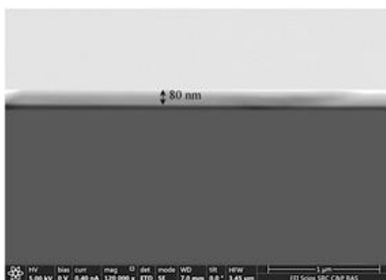
Рис.3. СЭМ-изображение поперечного сечения тонкой пленки \text{CrSi}_2 , сформированной магнетронным распылением на поверхности кремния в течение 120 с, затем отожженной при T = 720 \text{ K} в течение 1,2 ч.
