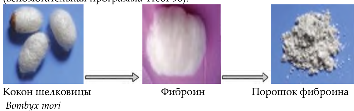
Рис. 1. Схематическое изображение получения порошка фиброина шелка.
